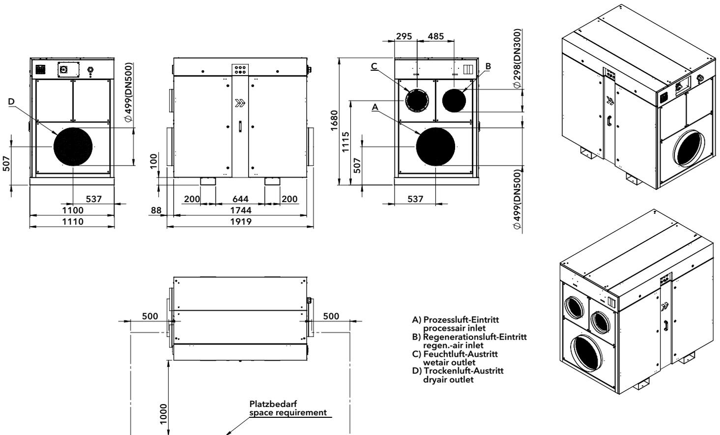
Änderungen vorbehalten. Alle Leistungsdaten beziehen sich auf 1013 mbar, eine Dichte von 1,2 kg/m³ und eine Spannungsversorgung mit 3x400 V/50Hz +PE bzw. 230V/50 Hz. Für ihre Projektauslegung empfehlen wir bzgl. der Entfeuchtungsleistung einen Sicherheitsabschlag je nach Anwendung in Höhe von 10-20 % zu berücksichtigen.
