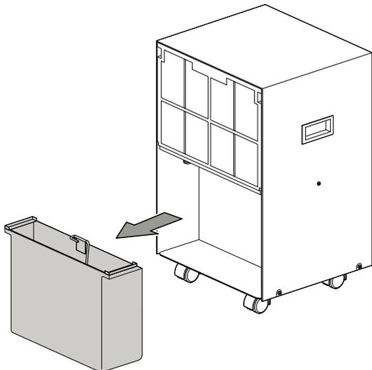
2. Entleeren Sie den Kondensatbehälter über einem Abfluss oder Spülstein.
