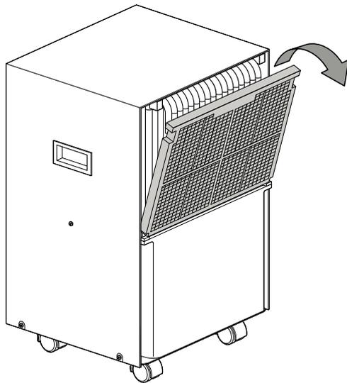
2. Säubern Sie den Filter mit einem weichen, fusselfreien, leicht angefeuchteten Tuch. Sollte der Filter stark verschmutzt sein, säubern Sie ihn mit warmem Wasser, vermischt mit neutralem Reinigungsmittel.
