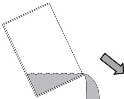
3. Spülen Sie den Kondensatbehälter mit klarem Wasser aus. Reinigen Sie den Kondensatbehälter regelmäßig mit einem milden Reinigungsmittel (kein Spülmittel!).
