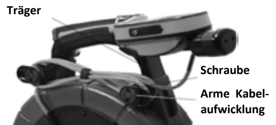
Abbildung 9: Träger und Arme der Kabelaufwicklung
