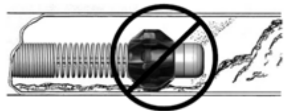
Abbildung 18: Antreffen eines Hindernisses- Hindernisse nicht mit dem Kamerakopf beseitigen
