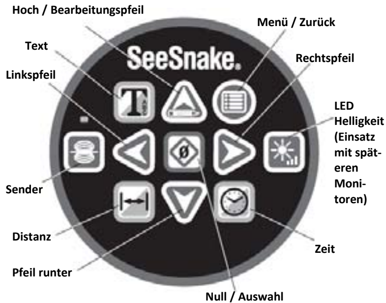
Abbildung 16: Bedienfeld Meterzähler (Nicht alle microReels sind mit einem Meterzähler ausgestattet)
