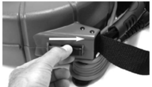
Abbildung 4: Entriegeln der microReel Trommel
