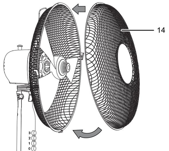
2. Stellen Sie sicher, dass alle Befestigungsklammern (15) die beiden Schutzgitter einspannen.
