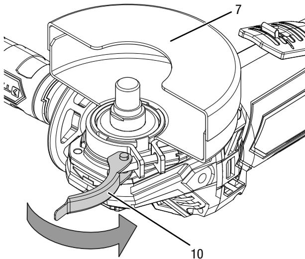
2. Drehen Sie die Schutzhaube (7) in die Arbeitsposition. Achten Sie darauf, dass die offene Seite der Schutzhaube zum Werkstück zeigt. Die geschlossene Seite der Schutzhaube muss stets zum Benutzer zeigen.
