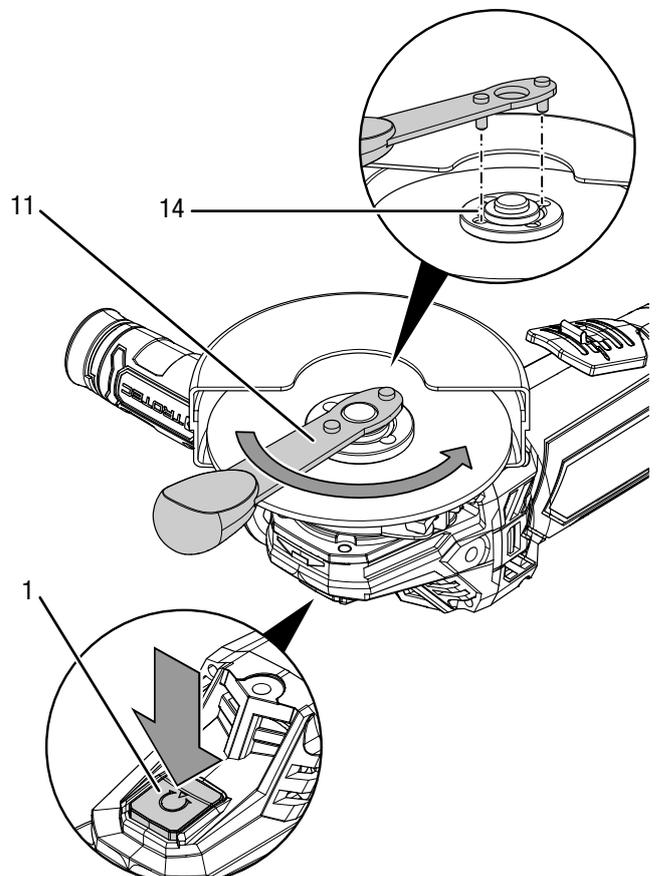
6. Entnehmen Sie die gebrauchte Trennscheibe (16). Achten Sie darauf, dass der Aufnahme­flansch (13) in den dafür vorgesehenen Aussparungen arretiert ist.
