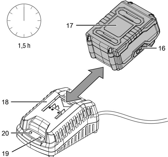
2. Stecken Sie den Netzstecker des Schnellladegerätes (18) in eine ordnungsgemäß abgesicherte Netzsteckdose.
